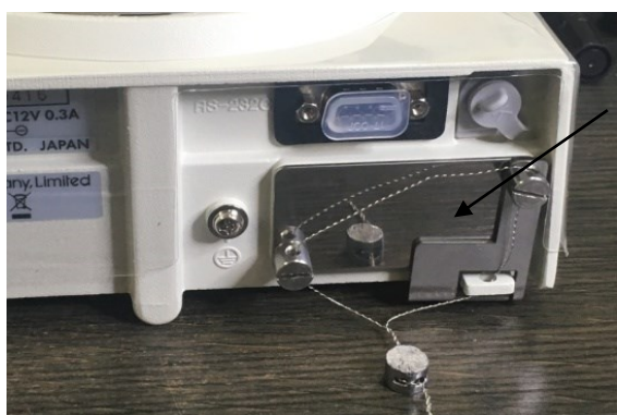
Рисунок 2 – Схема пломбировки от несанкционированного доступа, обозначение места нанесения знака поверки (1 – свинцовая или пластиковая пломба со знаком поверки в виде отиска поверительного клейма)
